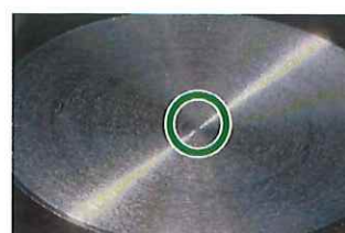
④ 再度端面を加工して心高さ調整完了
